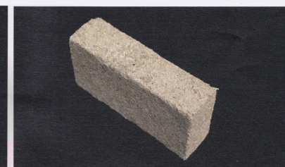
Lichte leemsteen bestaande uit klei- en strom, gevormd in een plastische toestand (met veel vocht), kan gebruikt worden voor scheidingswanden of opvulling van houtskeletwanden ter isolatie.
