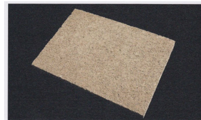
Leempaneel van een klei-zand mix en hennepvezels. Middelwaar bouw materiaal voor scheidingswanden.
